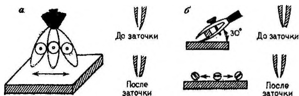
Рис. 8. Заточка рейсфедера: а – I прием; б – II прием
